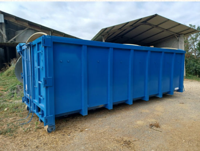
Benne ventilée utilisée pour le séchage et stockage des graines ©Gabb32
