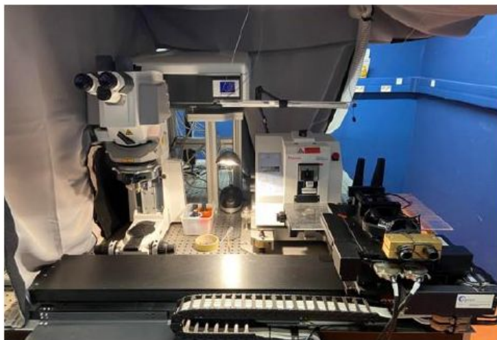
confocal/multiphoton couplé au vibratome (imagerie 3D d'organes) - prototype développé PHIV/Zeiss
