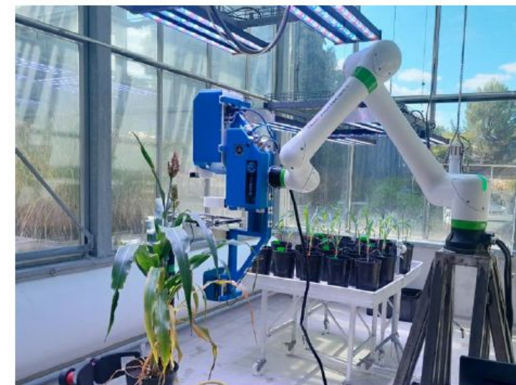
robot Imageur TéraHertz pour suivi de l'eau sur sorgho (CPER PlantEnvi)
